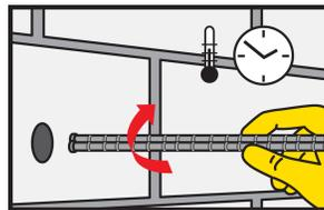
6. Insertar el anclaje con un ligero movimiento de giro en el orificio relleno de resina. Debe salir algo de adhesivo por exceso. Importante: El anclaje debe ser colocado durante el tiempo abierto de la resina.
