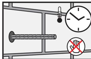
7. Durante el tiempo de endurecimiento de la resina no se debe mover o aplicar carga alguna. Se deben limpiar las herramientas inmediatamente con solvente convencional.
