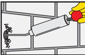
3. Cada vez que se limpie el orificio se debe soplar, con una bomba de soplado o aire comprimido, empezando desde el fondo del orificio. Importante: Usar compresores libres de aceite.
