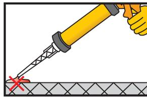
4. Presione hasta que se mezclen los dos componentes en la boquilla. No usar este material que sale sin mezclar. Dejar de hacer presión y limpiar la entrada del cartucho con un trapo.
