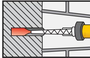
5. Inyectar el adhesivo en el orificio, empezando desde el fondo, llevando la boquilla hacia atrás progresivamente. En cualquier caso se debe evitar la entrada de aire.
