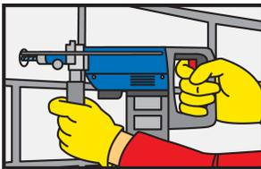
1. Realizar el agujero de diámetro y profundidad requeridos con un taladro roto-percutor. El diámetro del orificio debe ser entre 1/8 y 1/4 de pulgada mayor al diámetro de la barra a anclar.
